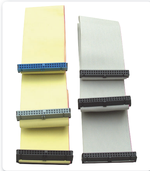
► Figura 3. Los cables planos deben tenerse en cuenta para realizar reemplazos.
