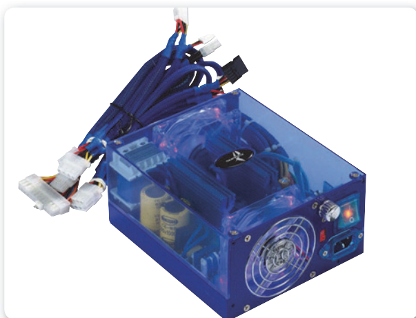
► Figura 7. La fuente de poder puede presentar diversas dificultades y, en muchos casos, es el origen de que el equipo no encienda.
