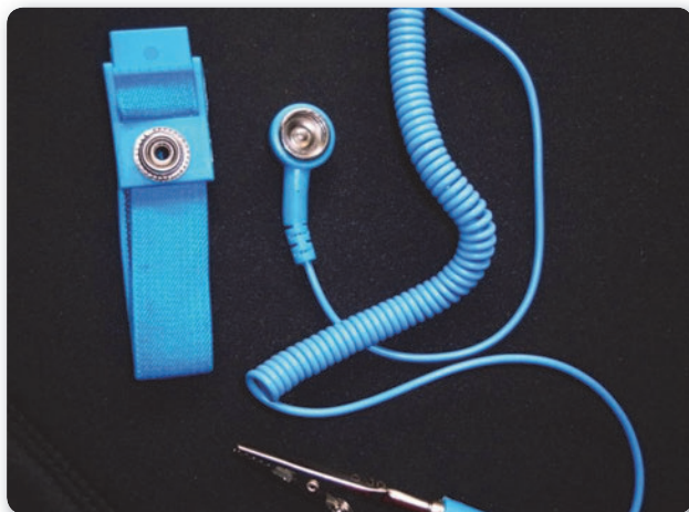
► Figura 4. Una pulsera antiestática es un elemento esencial para trabajar sin riesgo con los dispositivos electrónicos.
