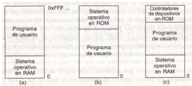
Figura 4-1. Tres formas sencillas de organizar la memoria con un sistema operativo y un proceso de usuario. También existen otras posibilidades.
